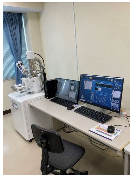
図1 理学部棟に導入された SEM-EDS
